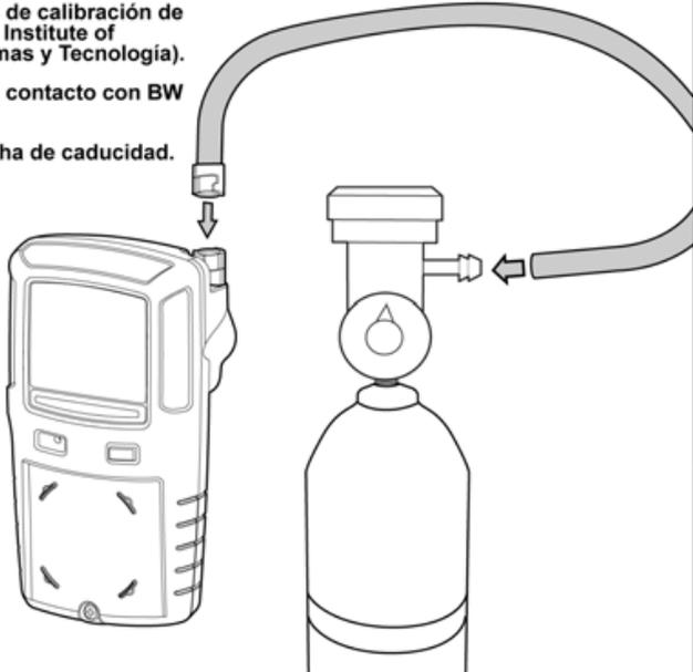
La calibración se debe realizar en un área segura y libre de gases peligrosos en una atmósfera de contenga un 20.9% de oxígeno. No se debe calibrar el detector durante o inmediatamente después de que se complete la carga.
