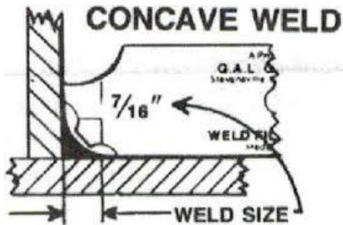
Coloque el borde del arco simple al ras del material base de manera que la punta de la hoja toque el miembro vertical. si la punta toca la soldadura cuando toca el miembro vertical, la soldadura tiene el tamaño indicado.
