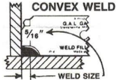
Coloque el borde del arco doble al ras del material base de manera que la punta toque el miembro vertical. si la punta entre el arco doble toca el centro de la soldadura, la soldadura tiene el perfil deseado y el tamaño indicado.
