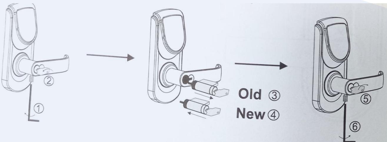
8.3 Batería externa de 9v (disponible cuando existen electrodos en la superficie inferior del cuerpo de la cerradura frontal)
