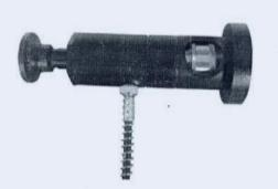
Instale la base de dolly de 50 mm en el mango del actuador.
