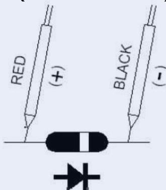
b. Cuando se conecta como se muestra en la Fig. 3, se realiza una verificación inversa del diodo. Si el diodo bajo prueba es bueno, se mostrara "OL". Si el diodo bajo prueba esta defectuoso, se mostrará "0.000" u otros números. Las pruebas de diodo adecuadas deben incluir ambos pasos a y b mencionados anteriormente.
