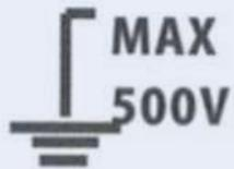
Este símbolo advierte al usuario de que los terminales así marcados no deben conectarse a un punto del circuito en el que la tensión con respecto a la tierra supere (en esta cubierta) los 500 VAC o VDC.
